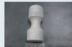
ダンベル型試作部材(焼結まま)
