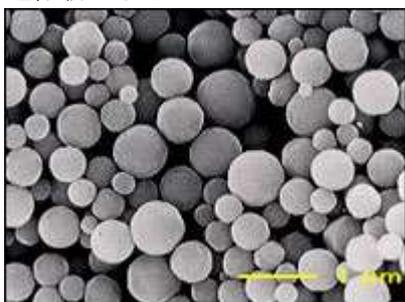
MLCC（積層セラミックコンデンサー）の内部電極材として使用されているニッケル粉の小粒径化を推進することにより、電子部品の小型化に貢献し、資源節約に寄与しています。
