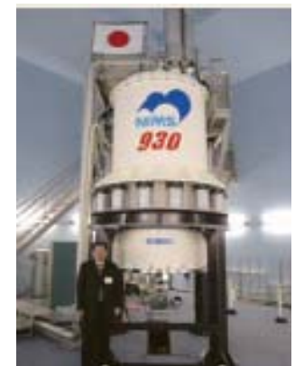
高性能核磁気共鳴装置(NMR)
