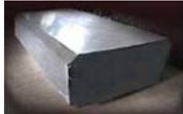
EB炉で製造されたチタンインゴット
