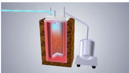
金属マグネシウムを入れた還元炉に四塩化チタンを滴下します
