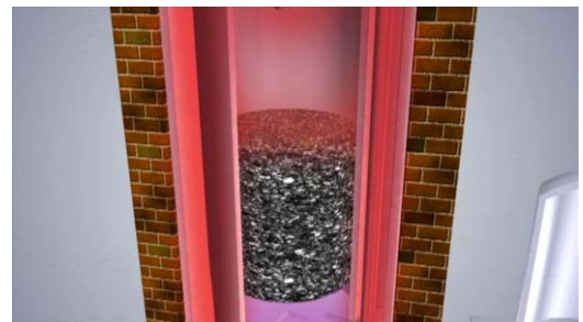
四塩化チタンと金属マグネシウムが反応し、スポンジチタンが生成します
