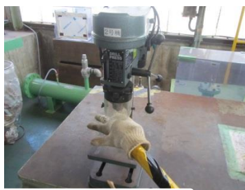
ボール盤巻き込まれ危険体感
