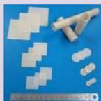
次世代リチウムイオン電池用固体電解質(リチウムランタンチタン酸化物)
