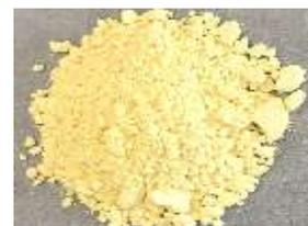
図5 可視光応答型光触媒酸化チタン粉末
