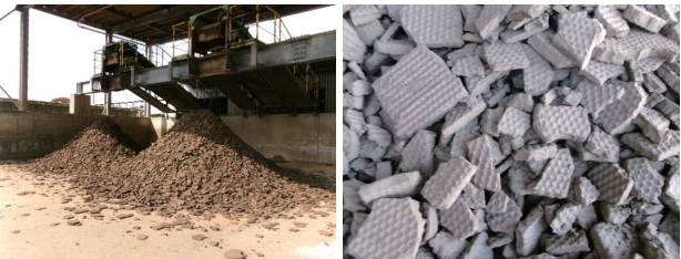
汚泥を乾燥させてプレスケーキにする
