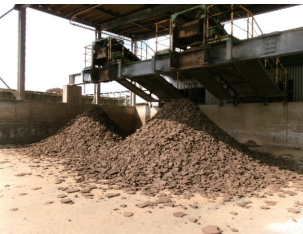
汚泥を乾燥させてプレスケーキにする
